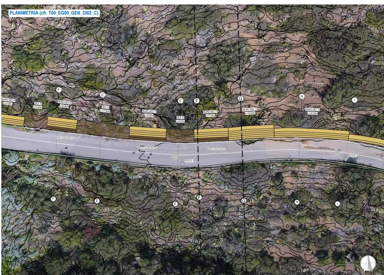
Figura D2 - Sezioni di progetto nel tratto di interesse e curve di livello ottenute da aerofotogrammetria con drone eseguita dal RTP durante la fase delle indagini in situ
