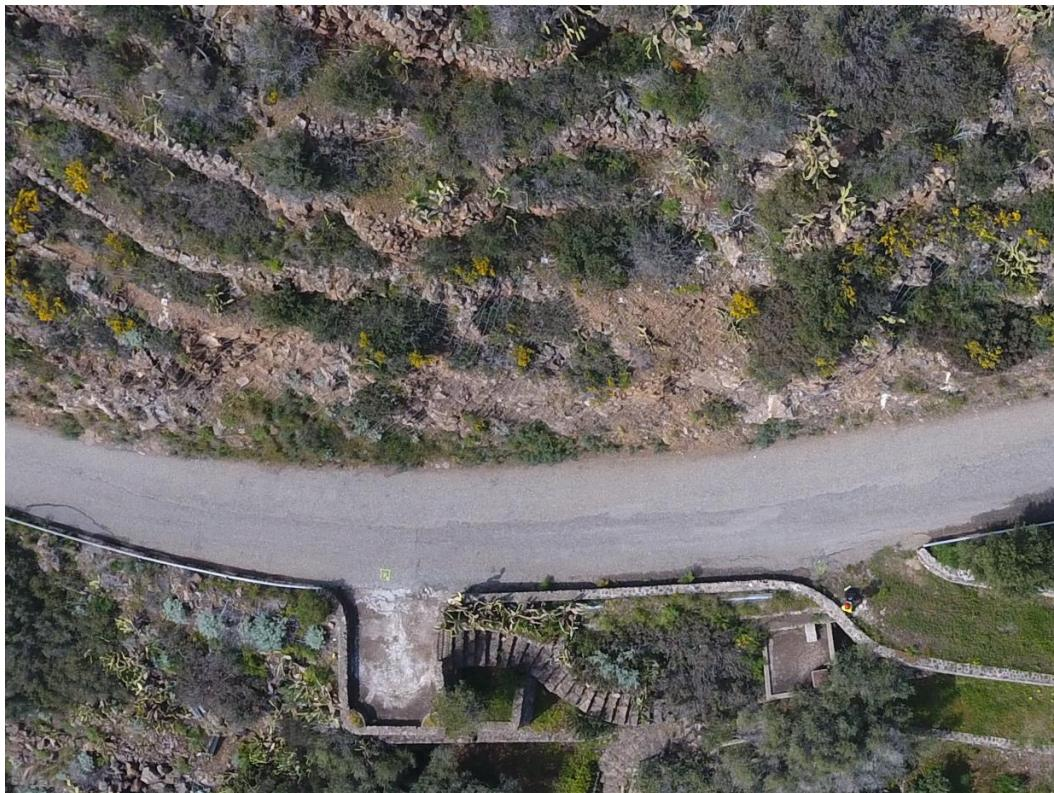
Foto 3 - Ripresa con drone 383 - Semplice rete a difesa strada fra quota 119m slm e quota 113m slm per una lunghezza di 150m con cavo di tenuta superiore disposto 15 m sopra il piano strada con pendio a 45° (superficie  $150 \times 15 \times 2^{0.5} = 3200 \text{m}^2$ )
