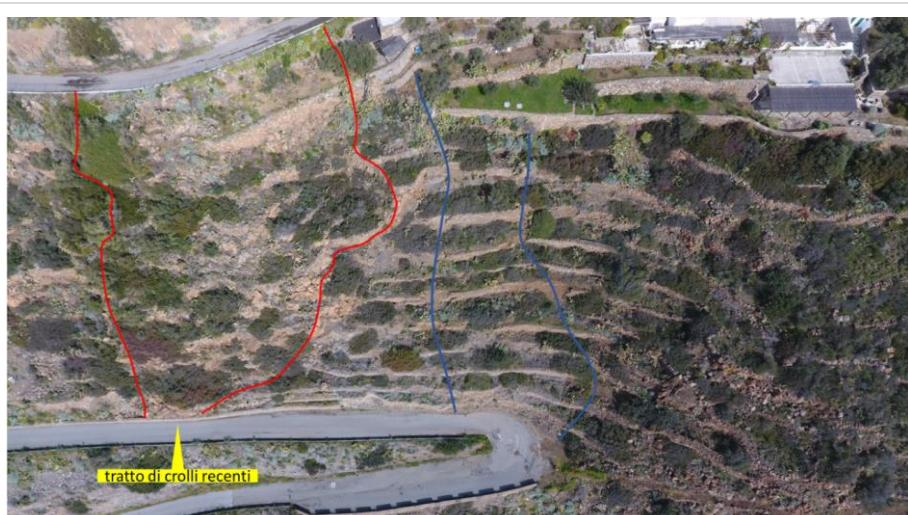
Figura 5 - Percorsi di corrivazione vecchi e nuovi ai piedi del rilevo Montagnola (da foto con drone marzo 2021)
