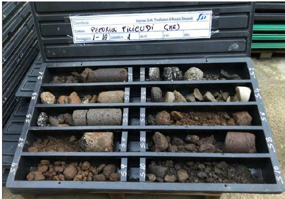
Figura 2 - Carote prelevate nel corso dei sondaggi
